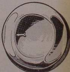
Orientation du piston (flèche vers l'avant). Coupe partielle d'un piston
