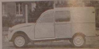
Ressemblant à la 2 CV, la fourgonnette « AK » est plus longue, elle utilise un châssis d'« Ami 6 ». En mai 1968 elle reçut le moteur M 28/1 et devint « ARK » très proche du moteur M 26. Il est un peu moins poussé (33 ch), avec un carburateur simple corps et un rapport volumétrique moins élevé
