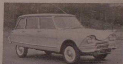
La version « club » des « Ami 6 » se distinguent par leurs projecteurs doubles, en remplacement des optiques rectangulaires et des baguettes caoutchoutées le long de la caisse. Leur confort est amélioré par des revêtements insonorisants et des sièges avant à dossier réglable.
