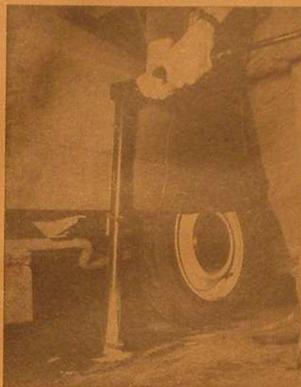
Mise en place du cric (Photo RTA)
