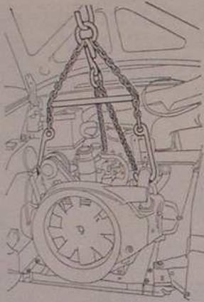
Dépose de l'ensemble moteur-boîte
